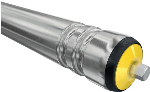
Las gargantas son ranuras longitudinales que se pueden practicar en los tubos de acero. Sirven para el guiado de correas redondas. Si se utilizan correas redondas adecuadas, éstas se encuentran por debajo de la superficie de los rodillos y, por tanto, no tienen contacto con el producto transportado.
