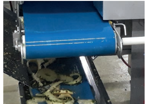
NOVAK S09UF y NOVAK 20CK en transporte de desecho de piña.
